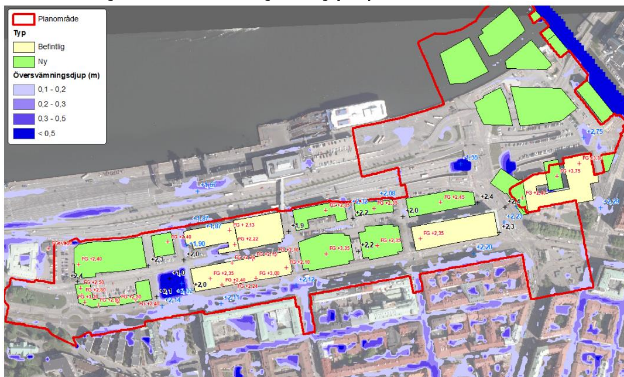
Figur 5. Utdrag ur simuleringsresultat av maximalt vattendjup vid ett skyfall motsvarande 100-årsregn med planförslaget för gällande detaljplan. Simuleringen är gjord med gällande detaljplans kvarterstruktur samt med de markhöjder som föreslås i GFS (2019-06-12). Blå plushöjder motsvarar vattenytans nivå vid ett skyfall och svarta plushöjder visar marknivåer enligt GFS. Alla höjder som anges som markhöjd har inte reglerats i den färdiga detaljplanen. Planen visar dock inga motstridiga höjder.
