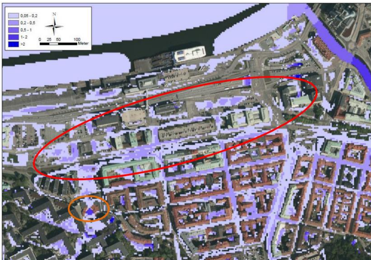
Figur 3. Utdrag från resultatet av simuleringen av 100-årsregn inklusive klimatfaktor, utifrån då befintliga förhållanden utan påbörjad utbyggnad av gällande detaljplan. Mörkare blå indikerar ett större vattendjup angivet i meter i de översvämningar som bildas. Skyfallsmodellen tar hänsyn till hela avrinningsområdet även områden utanför planområdet (markerat med en röd ring).
